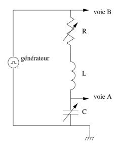
Le générateur est réglé pour délivrer des signaux rectangulaires dont on choisira la largeur et l'amplitude de manière à pouvoir observer correctement les oscillations sur l'écran de l'oscilloscope.
