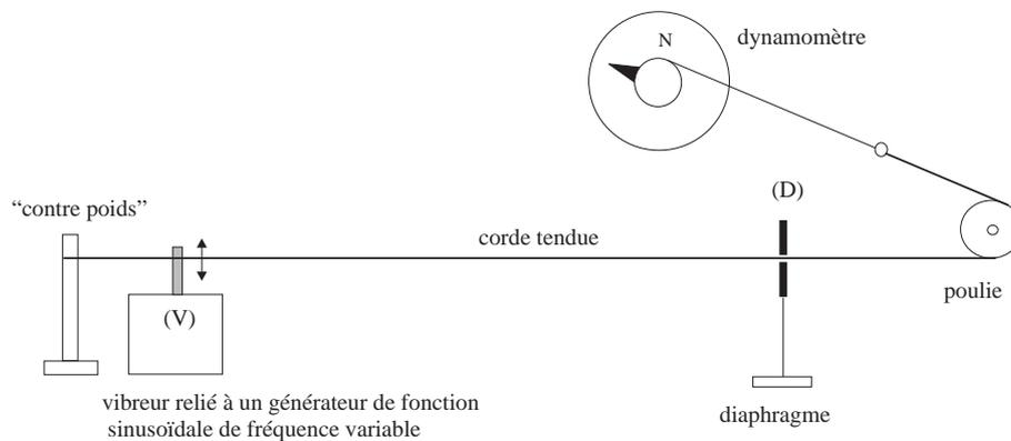
FIG. 2 – Dispositif expérimental pour l'étude des ondes transverses
