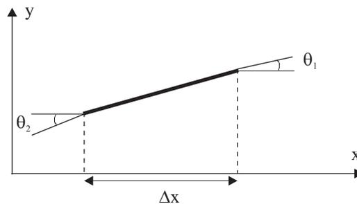
FIG. 1 – Schéma d'une portion de corde vibrant transversalement.
