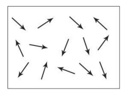
Paramagnétisme: désordre du aux fluctuations thermiques
