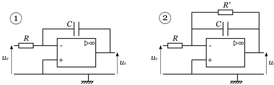
réponses : 1)  $\frac{1}{1+j\omega RC}$  3)  $\frac{1}{1+j\omega RC}$  4)  $t_{sat} = 150s$  6)  $A_0 = 0$  et  $\tau = RC$ ,  $E$  entraîne une tension de décalage en sortie  $U_s = -\frac{E}{R} = -1.6mV$ .
