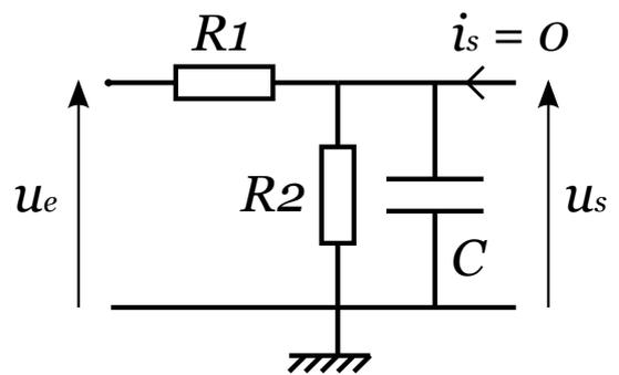
réponses : 2).  $C \cdot \frac{R_1 + R_2}{R_1 R_2}$  et  $\tau = \frac{R_1 + R_2}{R_2}$  3).  $A_0 = -2.5\text{dB}$ .  $G_{max} = 210\text{Hz}$ ,  $f_c = 210\text{Hz}$ ,  $\tau = 0.75\text{ms}$  4).  $u_s(t) = \frac{A_0 U_{em}}{\sqrt{1 + \omega^2 \tau^2}} \cos(2\pi ft + \alpha)$  avec  $\alpha = -\arctan(\omega\tau)$ , soit  $u_s(t) = 7.5 \cos(1307t - 0.1)$  [V].
