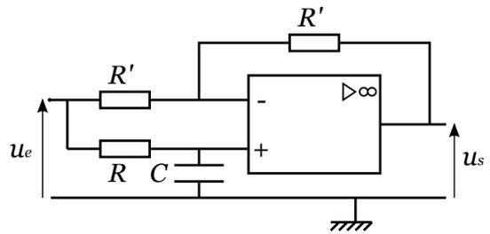
réponses : 1)  $\frac{1}{1+j\omega RC}$  3)  $\frac{1}{1+j\omega RC}$  4)  $t_{sat} = 150s$  6)  $A_0 = 0$  et  $\tau = RC$ ,  $E$  entraîne une tension de décalage en sortie  $U_s = -\frac{E}{R} = -1.6mV$ .
